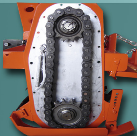
Καδένα μετάδοση κίνησης & ρύθμιση βάθους Side transmission by chain & depth adjustment
