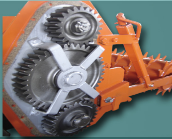
Σύστημα γραναζιών Side gears drive
